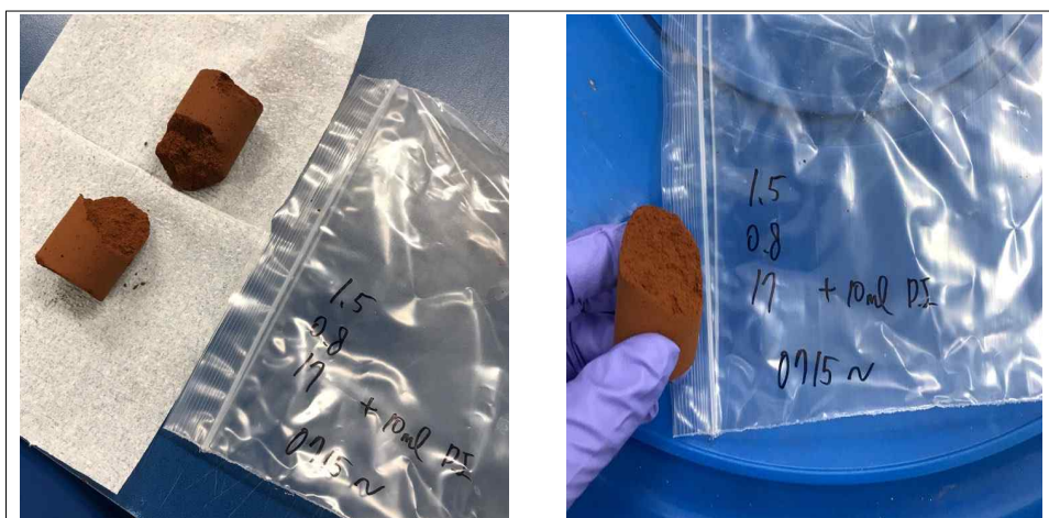
↑ H/Al 몰비율 17짜리 red mud + fly ash 고화체의 쪼개짐 현상 관찰
